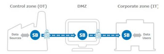
信頼性の高いソリューションの 1 つは、MQTT メッセージを別のフォーマットに変換し、サーバーからサーバーへ、目的地に到着するまでネットワークを受け渡すことができるようにすることです。MQTT データを生成するデバイスは、スマート・ブローカーのインスタンスに接続されます。データ変換可能なブローカーは、品質情報とともにデータを安全なプロトコルを介してスマート・ブローカーの別のインスタンスに渡し、ブローカーは、データを再び MOTT に変換します。
